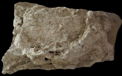
a. Mortier sur toute la surface
