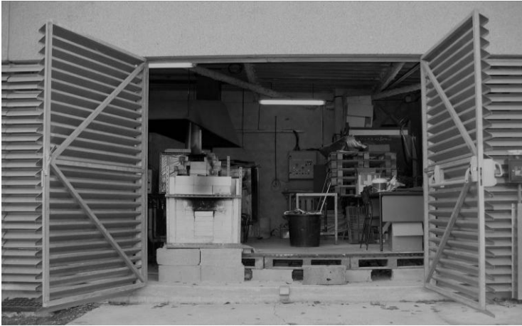
Figure n 17 : L'atelier de re-création situé au laboratoire de Bordeaux. Les portes sont composées de persiennes de métal tout comme les deux parois environnantes, pour laisser circuler les gaz. Sur la gauche on peut voir la face avant du four à bois utilisé pour les re-créations de lustre métallique ; sur la droite, du matériel (ph : C.Ollagnier, 2006).
