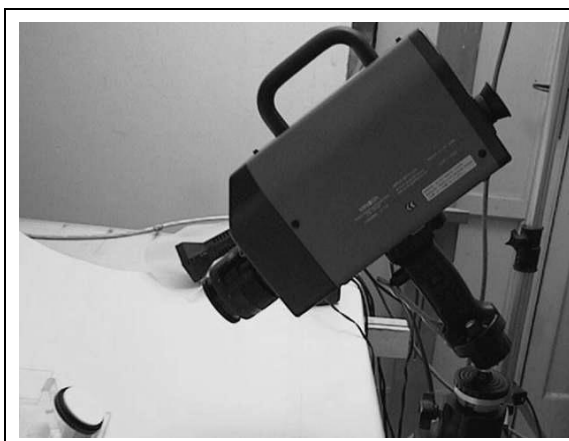
Figure n 11: Spectroradiomètre portable Minolta CS1000 in situ (Musée de la Céramique de Caltagirone, Italie) en cours de calibration avec un blanc référence Spectralon® SRS-99-020, de la société Labsphère® (ph : CRP2A).
