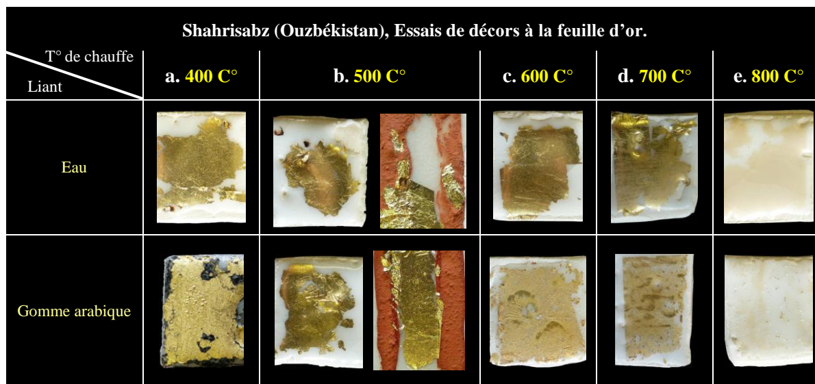
Figure n 178 : La feuille d'or ne présente aucune dégradation jusqu'à 500°C, qu'elle ait été posée avec de l'eau ou de la gomme arabique. Au-delà de ce cette température des différences apparaissent, le métal se dégradant peu à peu jusqu'à « disparaître » à 800°C. On note que cette disparition est plus rapide pour les carreaux ayant pour liant de la gomme arabique.
