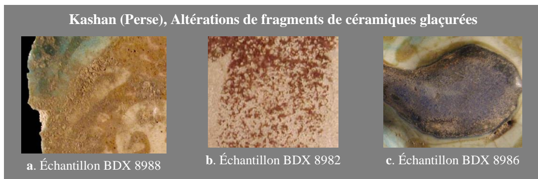
Figure n 39 : a. L'encroustement ocre jaune est bien visible en lisière du décor de même teinte et sur le turquoise. b. La desquamation de fragments de glaçure a entraîné la disparition d'une partie du décor brun. c. Les traces d'usure/frottement, donnent un contact rugueux au décor bleu.
