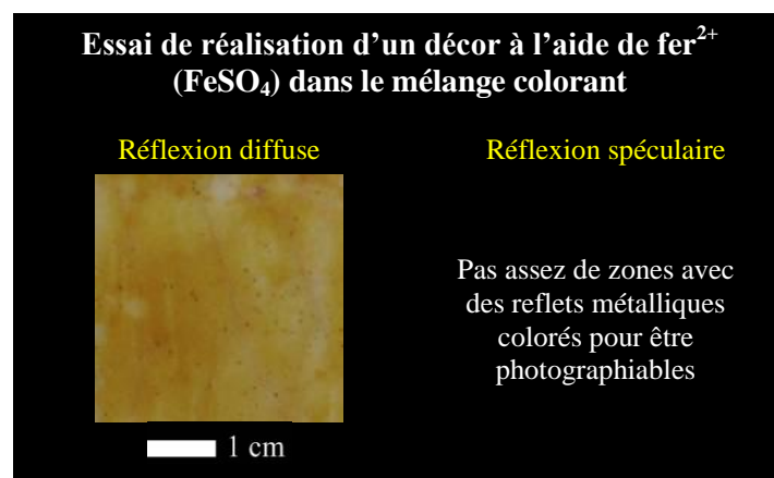
Figure n 82: photographie en réflexion diffuse du décor jaunâtre de l'échantillon BDX 10755, issu d'un mélange colorant à base d'argent et d'ocre dans un rapport de 1/5, auquel on ajoute du sulfate de fer 2+ ( \text{FeSO}_4 ), (ou « vitriol jaune »). Les reflets métalliques dorés sont tellement rares (au niveau des points sombres) qu'il est impossible de les photographier (ph : Ollagnier, 2007).
